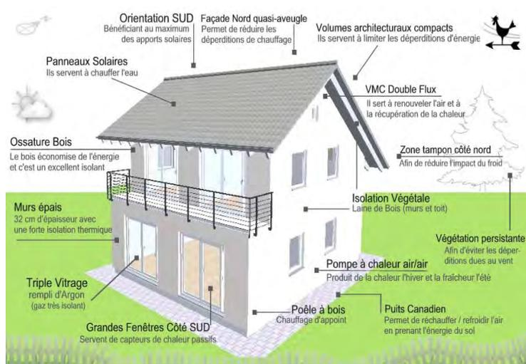
*Schéma de synthèse reprenant les choix constructifs, ainsi que les dispositifs d'isolation et de production d'énergie actuels, en fonction des différentes expositions (sources internet [www.active-travaux.com](http://www.active-travaux.com))*
