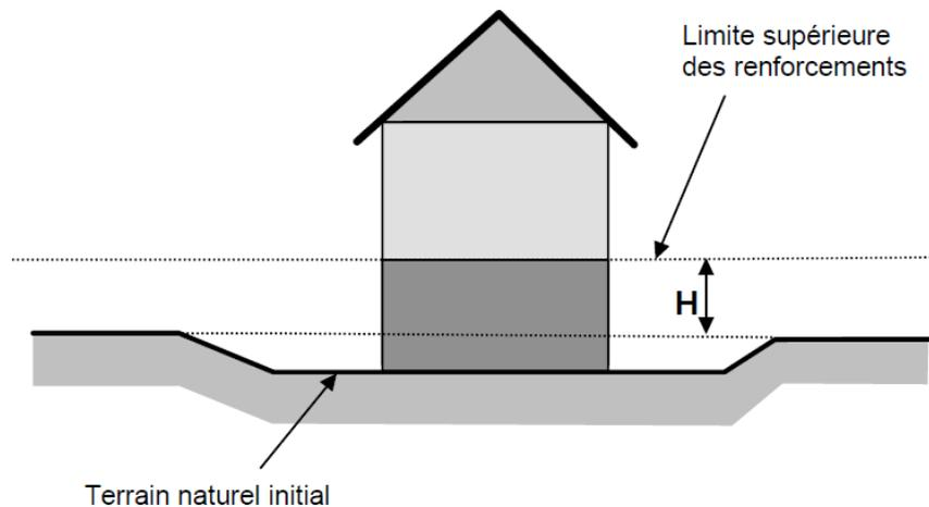
En cas de **terrassements en déblais**, la hauteur doit être mesurée par rapport au terrain naturel initial.
